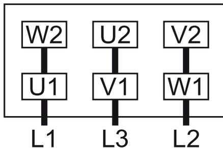
Connexion en étoile (haute tension) :
