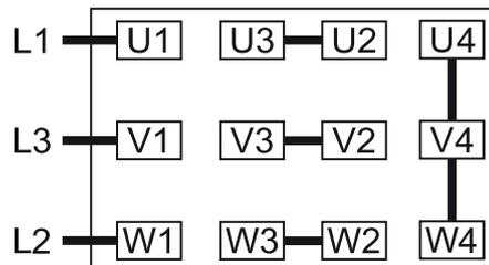
Connexion en triangle, moteur multi-tension à
