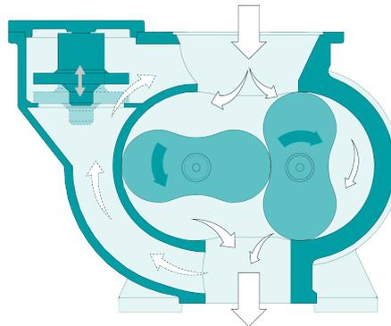
La machine fonctionne selon le principe de la soufflante booster
