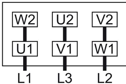
Connexion en étoile (haute tension) :
