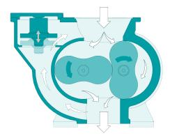
La macchina funziona in base al principio delle soffianti booster.
