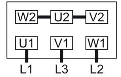
Collegamento a doppia stella, motore a multitensione con 12 pin (bassa tensione):
