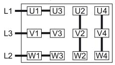
Collegamento a triangolo, motore a multitensione con 12 pin (media tensione):
