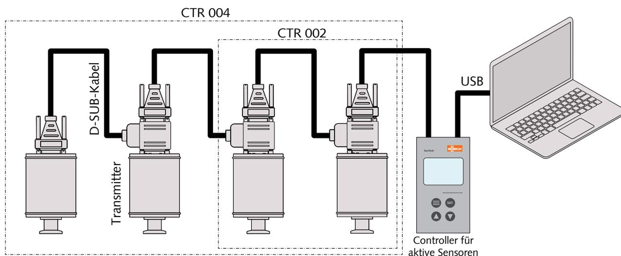
Mit dem Controller CTR 002 können bis zu 2 Messgeräte angeschlossen werden.
