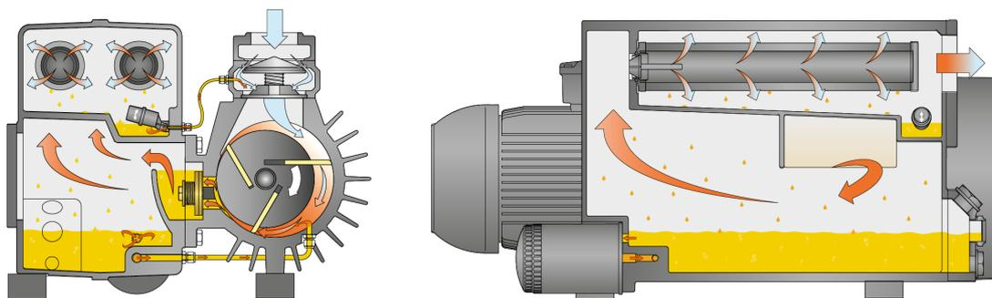
La machine fonctionne selon le principe des palettes rotatives.
