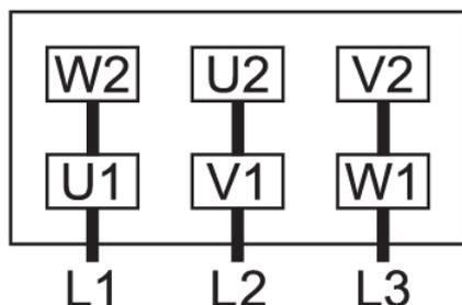
Connexion en étoile (haute tension) :
