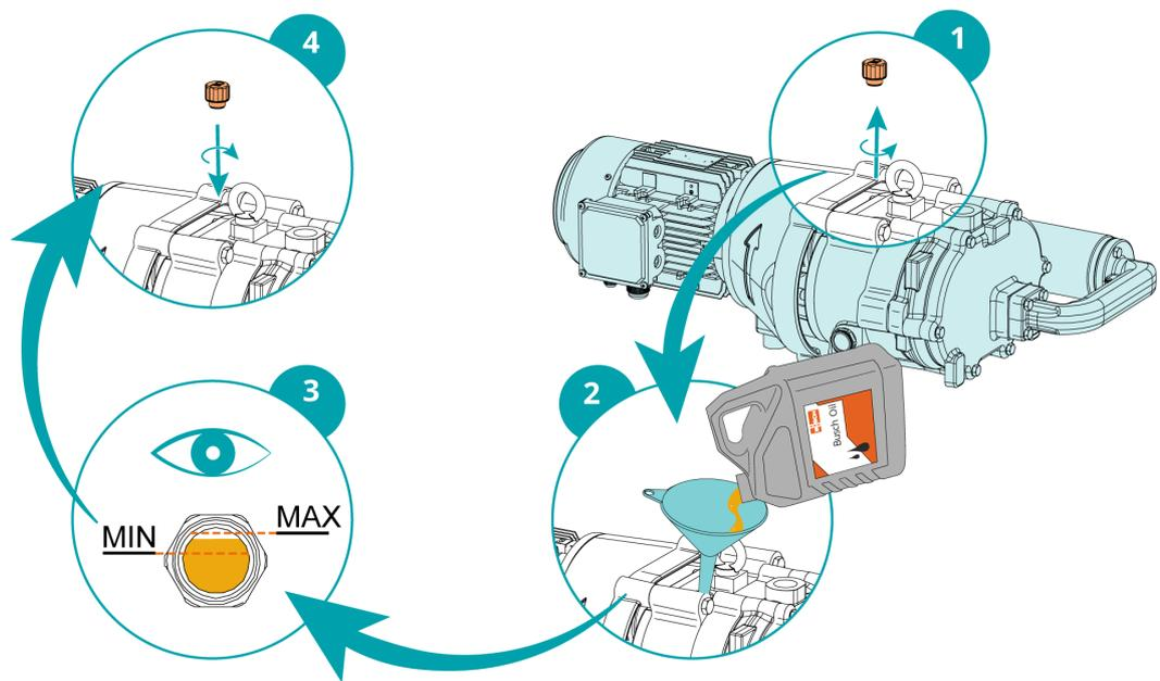
Le niveau d'huile doit rester constant pendant toute la durée de vie de l'huile. Une baisse du niveau indique une fuite et la Machine doit être réparée.
