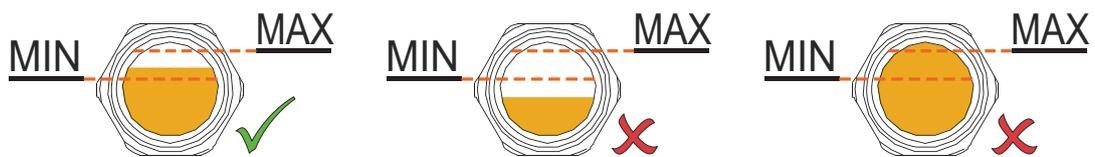
Le niveau d'huile doit rester constant pendant toute la durée de vie de l'huile. Une baisse du niveau indique une fuite et la Machine doit être réparée.
