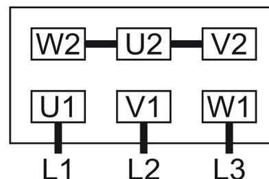
Connexion en étoile double, moteur multi-tension à 9 pôles (basse tension) :
