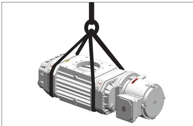
Si une pompe à vide sans moteur d'entraînement doit être soulevée, attacher une autre sangle à un point approprié. Si différents accessoires (bride de moteur, etc) sont montés sur la pompe à vide, prévoir également une sangle supplémentaire.
