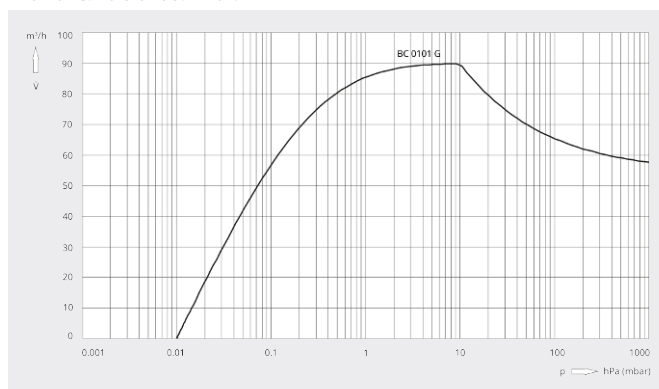
Velocidade de bombeamento Ar a 20 °C. Tolerância: ± 10%
