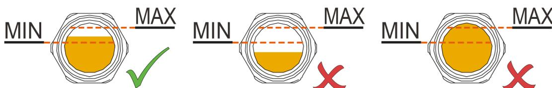
Le niveau d'huile doit rester constant pendant toute la durée de vie de l'huile. Une baisse du niveau indique une fuite et la machine doit être réparée.
