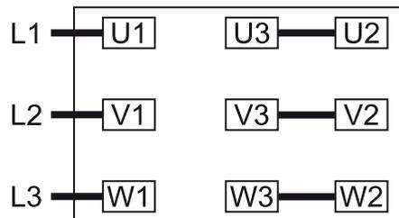
Connexion en étoile double, moteur multi-tension à 12 pôles (basse tension) :
