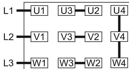
Connexion en triangle, moteur multi-tension à 12 pôles (moyenne tension) :
