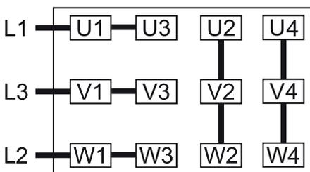
Connexion en étoile, moteur multi-tension à 12 pôles (haute tension) :
