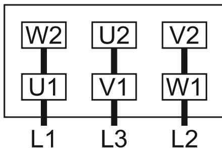
Connexion en étoile (haute tension) :
