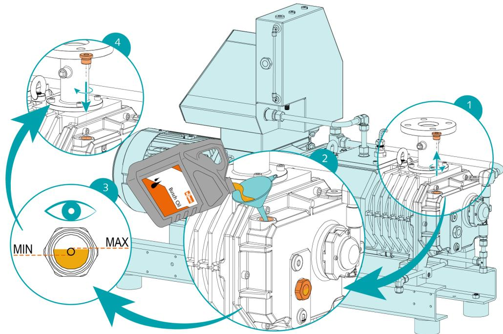
Nach dem Befüllen mit Öl:
