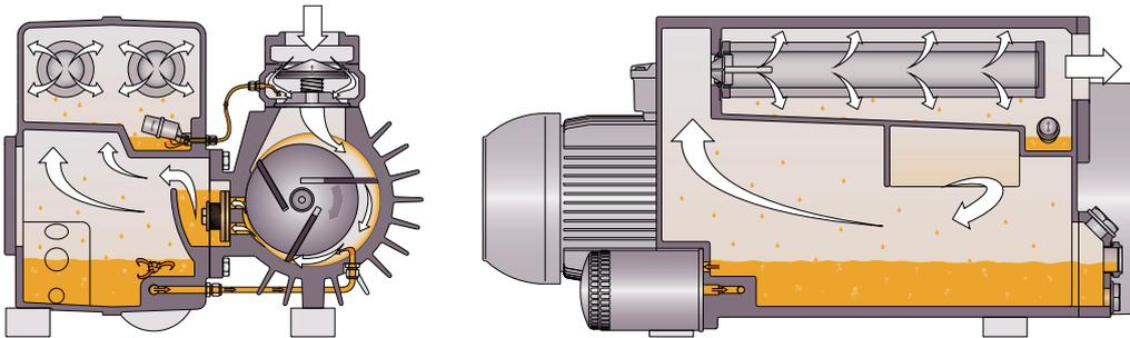
Die Maschine funktioniert nach dem Drehschieberprinzip.
