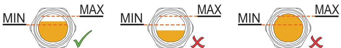
El nivel de aceite debe mantenerse constante durante su vida útil. Si desciende, esto indica una fuga y la máquina necesitará reparación.
