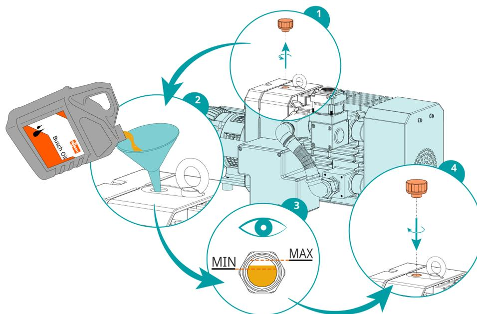
El nivel de aceite debe mantenerse constante durante su vida útil. Si desciende, esto indica una fuga y la máquina necesitará reparación.
